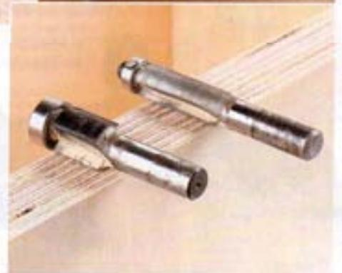
Einige Chassis (wie der Exponential-Bass aus der Tempus) haben nur kleine Öffnungen zum Boxinnenraum. Hier empfiehlt es sich, den Lautsprecherausschnitt rückwärtig zu erweitern. Mit dem Fasenfräser fahren wir im Uhrzeigersinn durch die vorher gefräste Rundung, auch hier gilt die einfache Regel von vornhin: Fräsung links-Oberfräse von uns weg, Fräsung unter dem Fräskopf - nach links bewegen!
