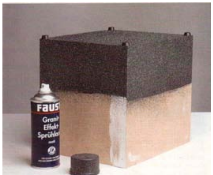
Im Boden werden die Löcher für die Gummifußschrauben vorgebohrt, damit das MDF nicht aufreißt.
