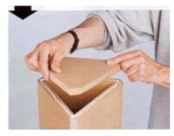
Bei passendem Zuschnitt sind Boden- und Deckelbereich eben. Aus der Flasche wurde Fugenleim aufgetragen und das grob zugeschnittene Brett aufgelegt. Durch das eigene Gewicht war der Deckel innerhalb von wenigen Minuten so fest, dass die Box umgedreht und der Boden eingeklebt werden konnte.
