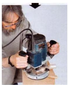
Die überstehenden Kanten von Deckel und Boden entfernte der Bündigfräser (wir empfehlen hier einen Blick auf die Internetseite von Nepata www.lignos.de) rückstandslos in einem Arbeitsgang.
