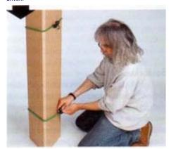
Mit der gleichen Prozedur wurde der uniere Teil des Korpus zusammengezogen. Im noch feuchten Leim "schwammen" die MDF-Platten automatisch in die gewünschte Position. Der Druck schob sie nach außen, das sie umschließende Gummiband ließ ihnen aber nicht genügend Platz, um über ihr Ziel herauszuschießen.
