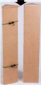
Jeweils zehn Minuten Säge- und Klebearbeit und nach dem Trocknen des Leims abschließend pro Box fünf Minuten Schleifen ließen ohne großen Aufwand, und vor allem problemlos eine Lautsprecherbehausung entstehen. die weit entfernt ist von der üblichen Rechteckform.
