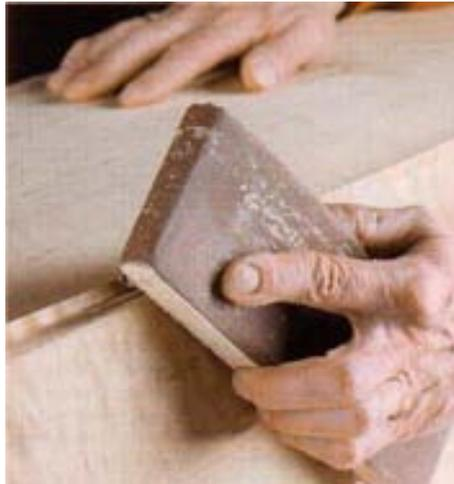
Vorsichtig das Furnier nach oben biegen und mit dem Schleifklotz im rechten Winkel abschleifen. Der Schleifer darf dabei nicht gegen die Maserung der anderen Furnierfläche bewegt werden.
