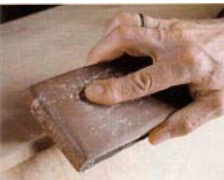
Die Furnierreihenfolge ist Seite, Seite, Rückwand, Front (Boden) und Deckel. Bei der Bearbeitung der Rückwand stoßen erstmals zwei Furniere aneinander. Um die Kanten nicht zu beschädigen, werden von nun an alle Schliffe mit dem Schleifklotz ausgeführt, auch wenn es länger dauert und mehr Körpereinsatz verlangt. Überstehendes Furnier wird zuerst von oben an-, jedoch nicht durchgeschliffen.
