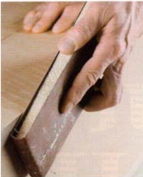
Überstehendes Furnier mit dem Schleifklotz im rechten Winkel nacharbeiten. Box umdrehen und die 2. Seite einleinen und trocknen lassen. In der Zwischenzeit kann man rauchen oder Kaffee trinken gehen (es dauert wieder etwa 20 Minuten) oder aber sinnvollerweise die 2. Box bearbeiten.
