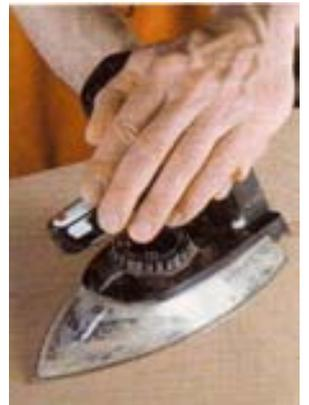
und mit gleichmäßigem Druck auf den hinteren Teil des Bügels zu den Seiten und nach oben und unten geführt. Sollte es sehr verspannen oder stark wellig sein, darf es mit einem Schwamm leicht angefeuchtet werden. Dadurch vermeidet man Risse in Faserrichtung. Eine streichelnde Handprobe macht hörbar, ob das Furnier überall gut klebt (an der Stelle, wo ein heller Ton ertönt, muss man noch einmal überbügeln).
