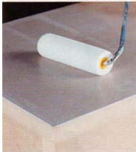
Nachdem die ungelochten Boxen glattgeschliffen sind, wird bei beiden die erste Seitenwand mit der Rolle gleichmäßig dünn eingeleimt. Eine durchscheinende weißliche Leimfläche bedeckt das MDF.
