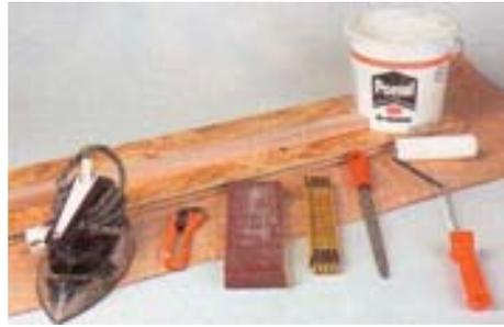
Alles, was der Mann braucht: Furnier (bekommt man in Schreinereien oder Holzhandel), Holzleim, Teppichmesser mit Schneidunterlage und Anschlagleiste, Zollstock, dreieckige Metallfeile, Schleifklotz (150er Bandschleiferschleifband auf Holzbrett), Schaumstoffrolle und Bügeleisen.
